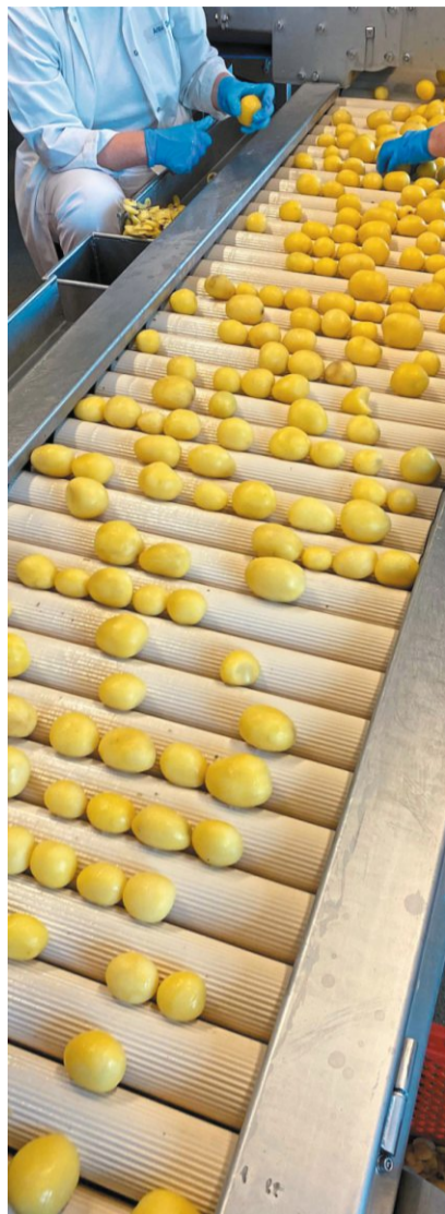
Schälstraße: Automatisiert und von Hand werden Kartoffeln geprüft.
