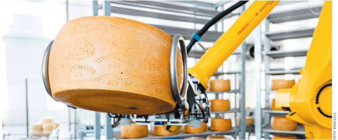
Automatisiert: Roboter übernehmen in dem neuen Lager von Brazzale sämtliche Warenbewegungen.
